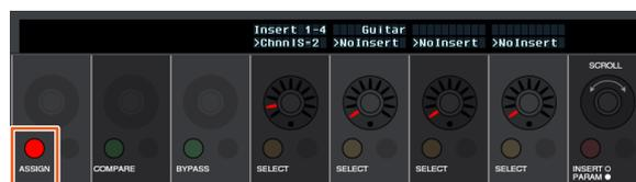
6. Girare il 16° [Knob multifunzione] da sinistra della sezione CHANNEL STRIP del Nuage Fader (il knob all'estrema destra), quindi selezionare nel gruppo A – D o E per cui viene utilizzato l'inserimento.
