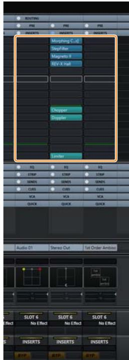
Gli slot di inserimento sulle channel strip possono essere selezionati mediante [▲][▼] nella sezione SECTION CONTROL.
